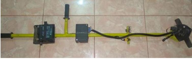
Hasil Akhir Alat Pemotong Rumput Elektrik Berbasis Mikrokontroler
