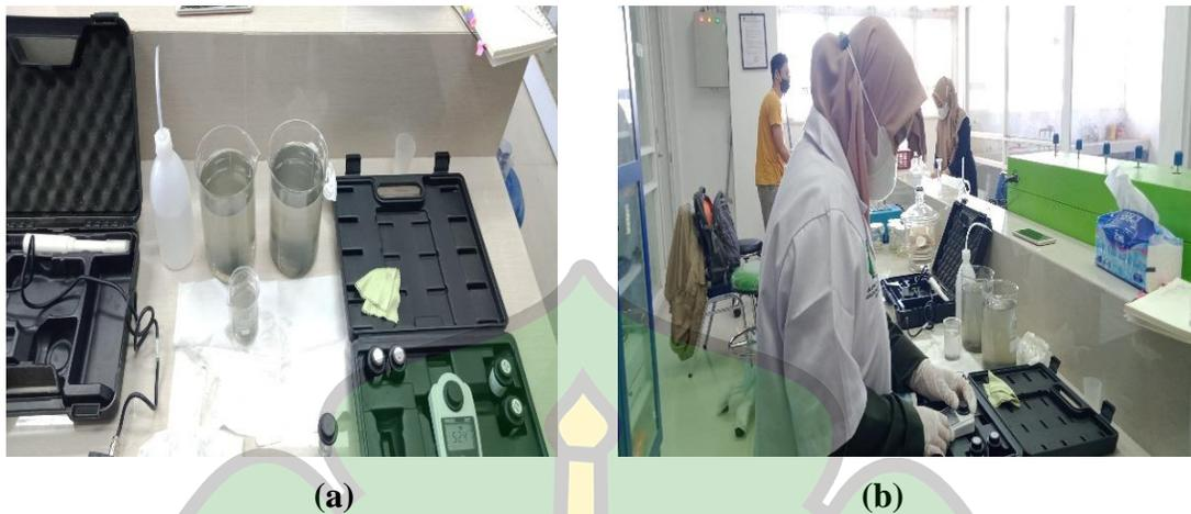
**Gambar 3.8** Menunjukkan (a) alat turbidimeter dan (b) proses pengukuran kekeruhan
