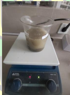
Gambar 3.10 Penghomogenan sampel dengan magnetic stirrer .
