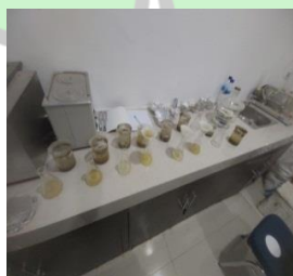
Gambar 3.13 Penyaringan sampel dengan kertas saring whatman No.42.
