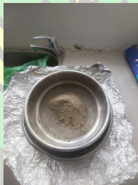
Gambar 3.8 Pengayakan sampel dengan saringan mesh 100.
