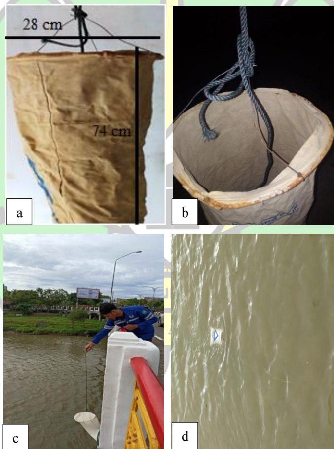
Gambar 3.3 Alat perangkat sedimen (a) tampak samping, (b) tampak atas, (c) penarikan alat perangkat sedimen, (d) alat saat pengambilan sampel.
