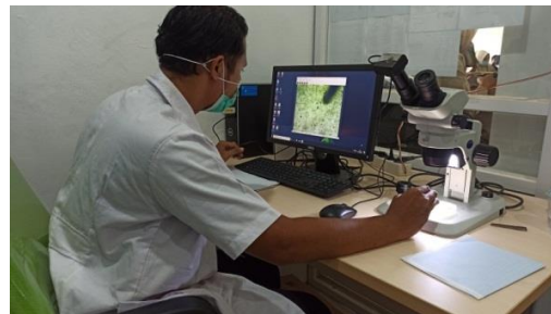
Gambar 3.14 Identifikasi mikroplastik menggunakan mikroskop.
