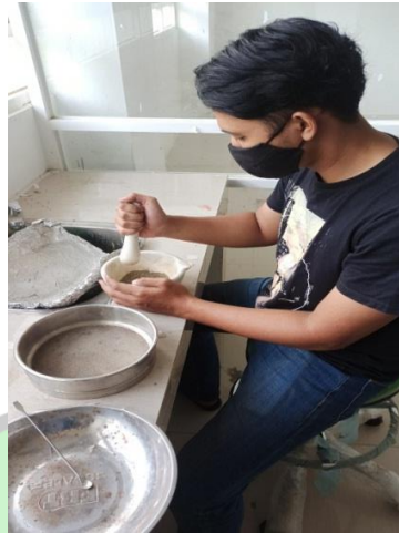
Gambar 3.7 Penghalusan sampel dengan alu dan mortar.
