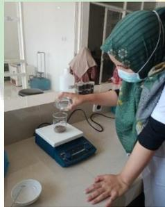
Penuangan HCl 1,0 M ke adsorben
