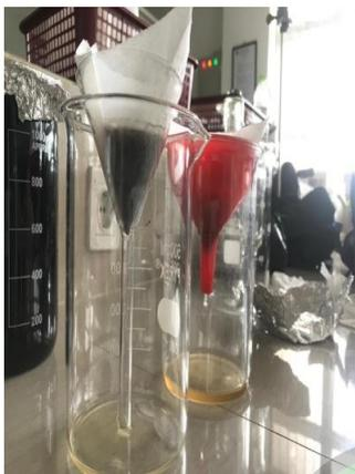
**Gambar 1.7** ampas kopi disaring dan dicuci menggunakan aquades
