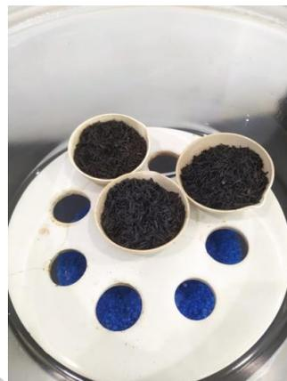
**Gambar 1.9** sekam padi yang baru dikeluarkan dari furnace
