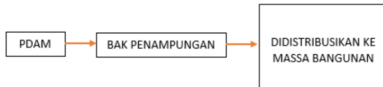
Gambar 5. 26 Skema Air Bersih Sumber : Analisa Pribadi
