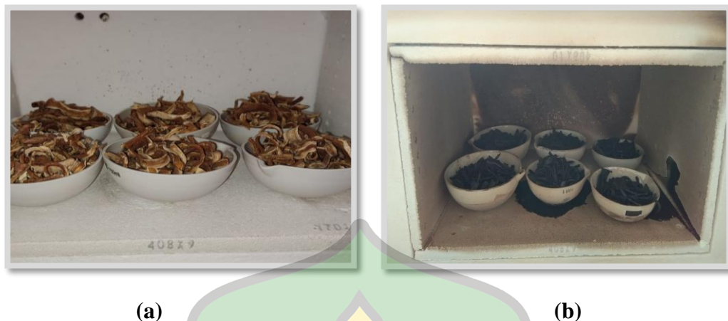
Gambar 4.5 Proses Karbonisasi Kulit Singkong (a) sebelum difurnace dan (b) setelah difurnace
