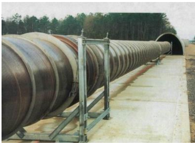
Gambar 4.10 Segmen yang terbuka dari tabung vakum LIGO Livingston. (sumber: Caltech / MIT / LIGO Lab) yang sangat penting dari kemungkinan kerusakan lingkungan. (sumber : Caltech / MIT / LIGO Lab)
