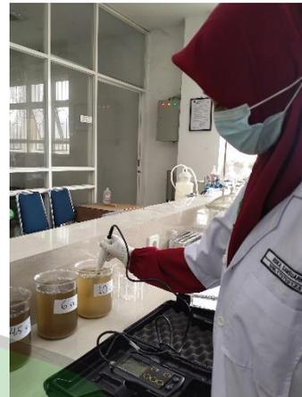
Proses pengukuran pH menggunakan pH meter
