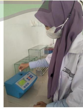
Proses pengukuran COD sampel limbah RPH menggunakan *COD meter*
