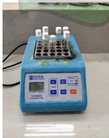
Proses pemanasan sampel menggunakan COD reaktor selama 2 jam
