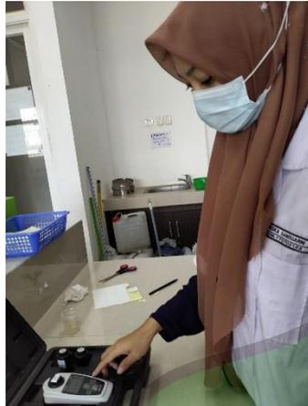
Proses pengukuran kekeruhan menggunakan turbiditimeter
