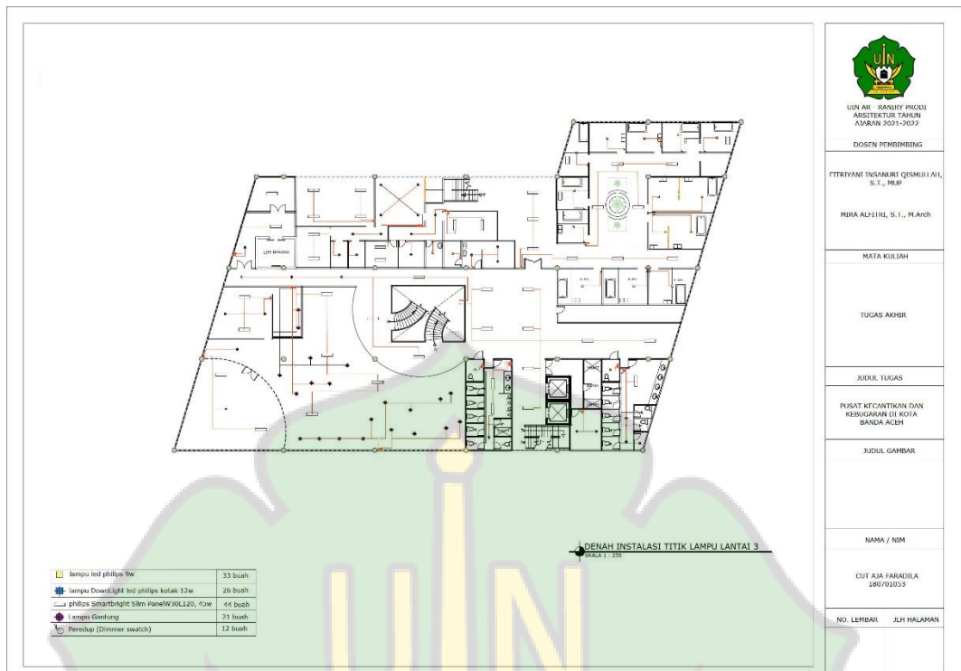
Gambar 6. 56 Denah titik Lampu Lantai 3 Sumber : Dokumen Pribadi
