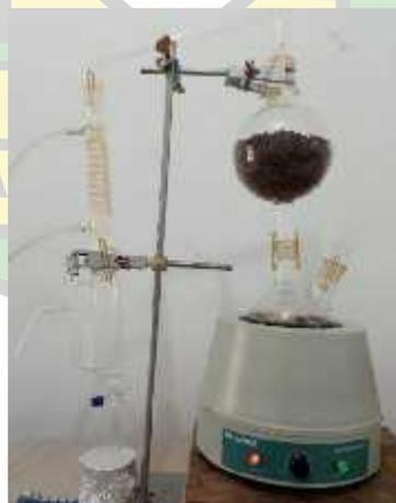
**Gambar 3** Proses isolasi minyak atsiri bunga cengkeh dengan metode destilasi uap air
