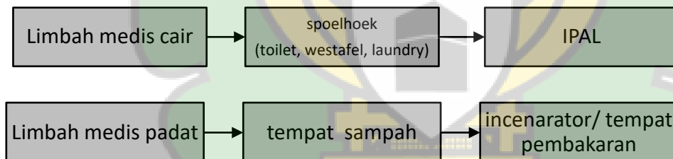
Gambar 5 21 Skema Pembuangan Air Kotor Medis Sumber : Analisa Pribadi, 2022
