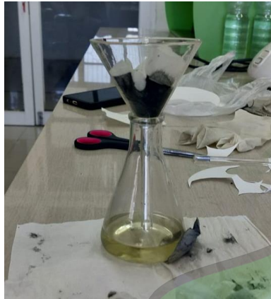
Proses ekstraksi dengan cara pengadukan fly ash dengan larutan HCl dan disaring menggunakan kertas whatman 41.
