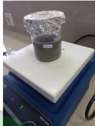
Proses ekstraksi dengan cara pengadukan fly ash dengan larutan HCl dan disaring menggunakan kertas whatman 41.
