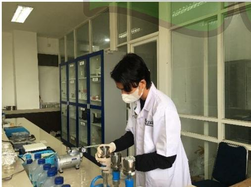
Proses analisis TSS menggunakan vacuum filtrasi
