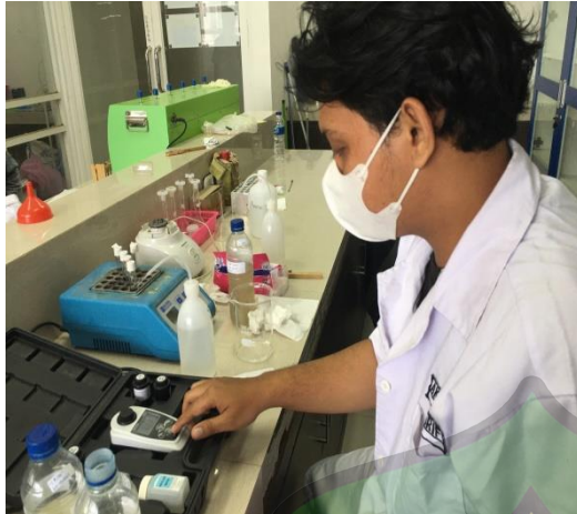
Proses analisa nilai turbiditas menggunakan Turbidimeter di Lab Teknik Lingkungan
