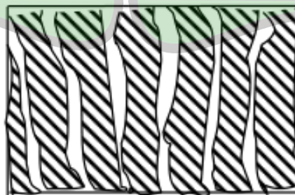
Gambar II.4 Membran simetrik (Sumber: Mulder, 1996)
