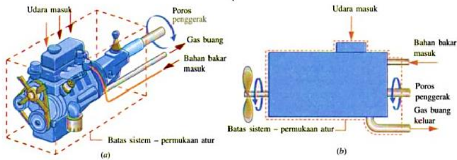
Gambar 2. Volume atur (sistem terbuka) mesin mobil Sumber: Buku termodinamika teknik Jilid 1
