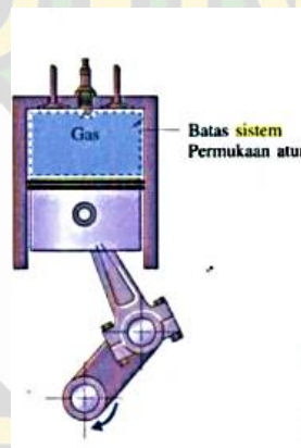
Gambar 3. Massa atur (sistem tertutup) gas dalam sistem torak-silinder Sumber: Buku termodinamika teknik Jilid 1
