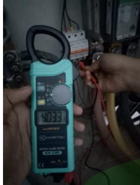
a) Tegangan fasa S-T pada panel MDP ketika diukur dengan tang ampere
