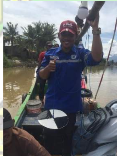
Pengukuran Kualitas Air Menggunakan Secchi Disk
