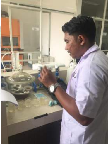
Proses Penuangan Sampel Kedalam Botol Lutron Turbidimeter
