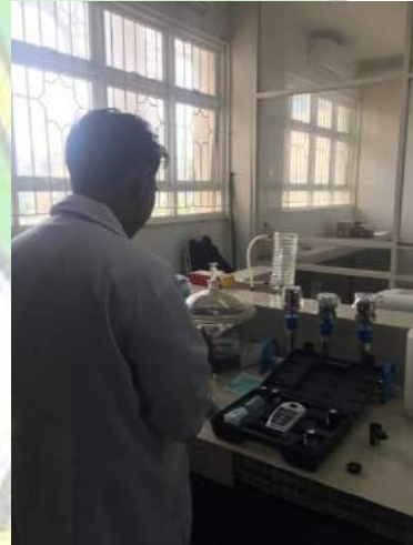
Pengukuran kekeruhan dengan menggunakan Turbidimeter
