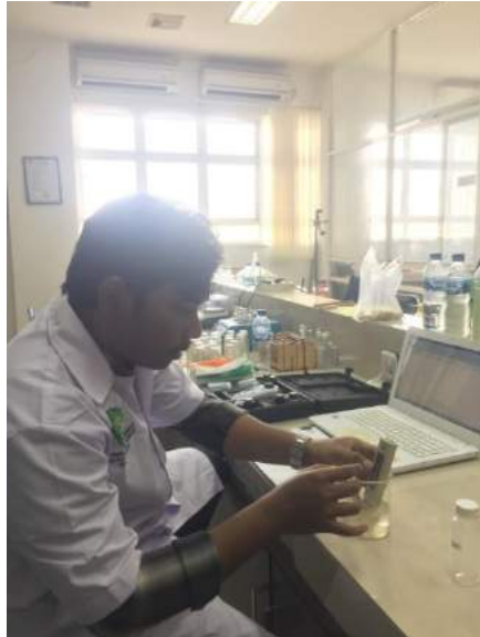
Proses pengukuran Total Dissolved solid menggunakan TDS meter
