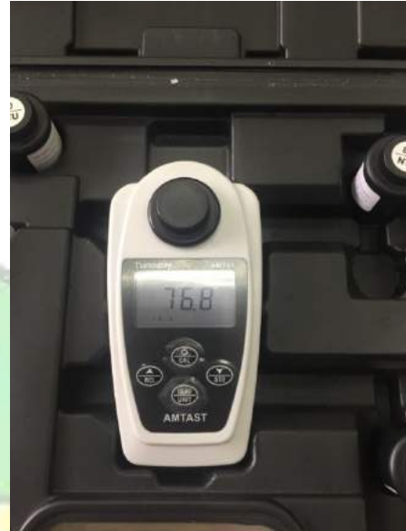
Hasil Pengukuran Parameter Kekeruhan (NTU) Menggunakan Turbidimeter
