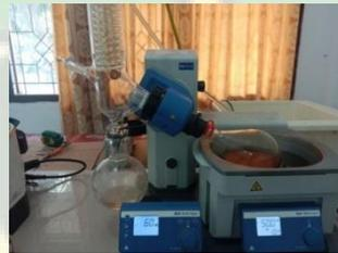
5. Dievaporasi maserat menggunakan *vacuum rotary evaporator* pada suhu 50°C
