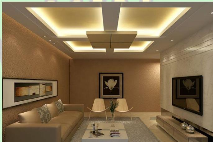
**Gambar 5.19** Ilustrasi Bentuk *Drop Ceiling*
