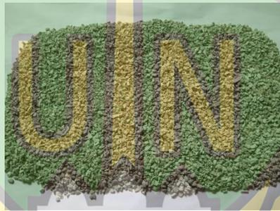
**Gambar 4.1** Zeolit ukuran 10 mesh
