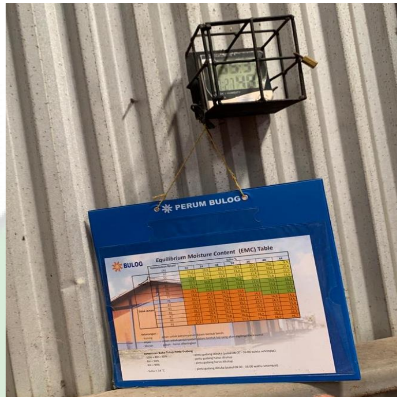
Alat Untuk Mengukur Suhu Ruang dengan Berstandar ISO (International Organization for Standardization)
