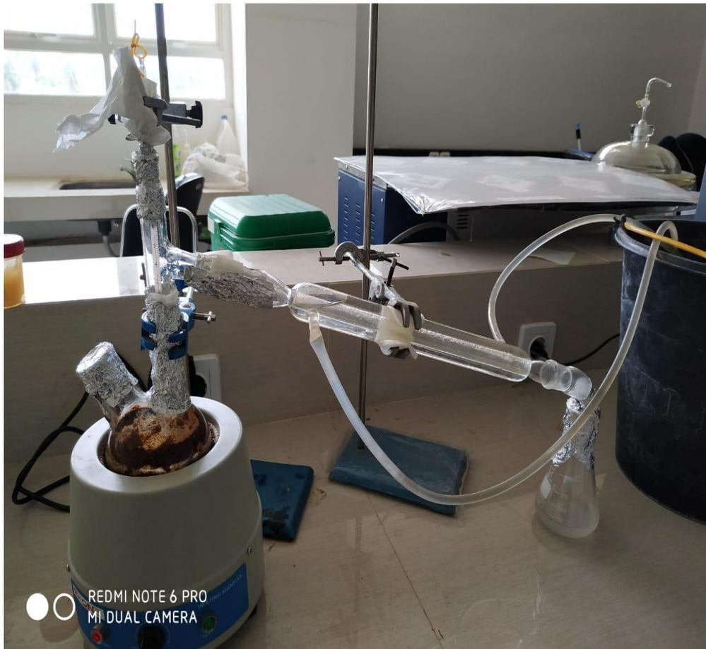
**Gambar 11.** Proses penyulingan minyak dari serbuk biji pala
