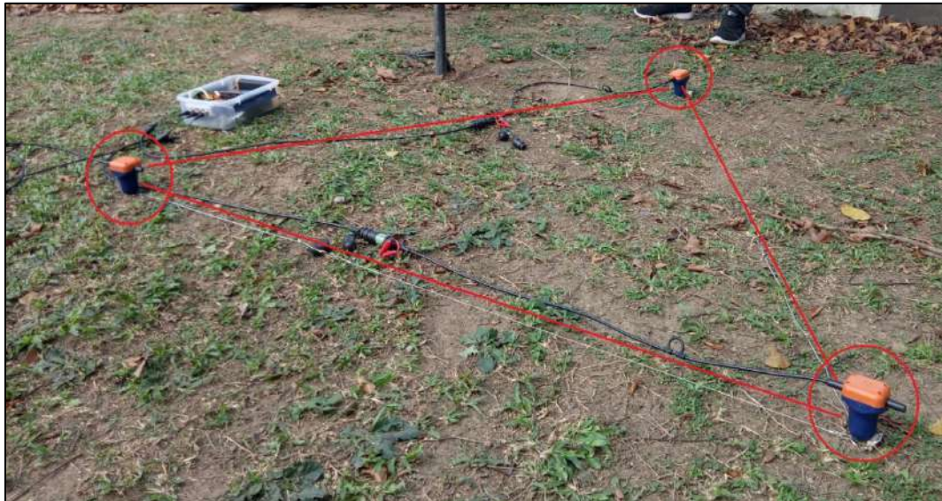
Gambar 3-4 Susunan geophone 5 Hz dengan array segitiga untuk mengukur gelombang seismik
