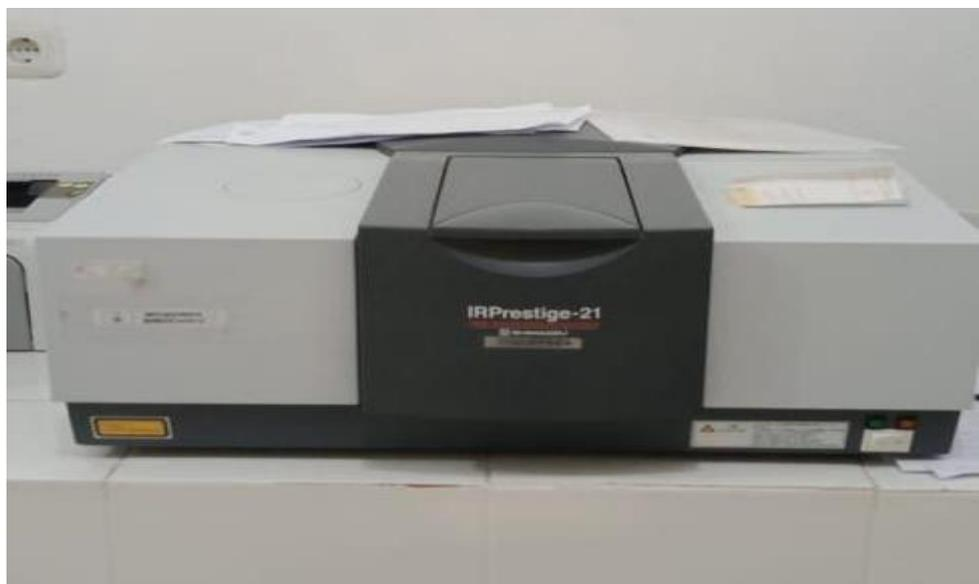
Gambar 14. Alat Uji FTIR
