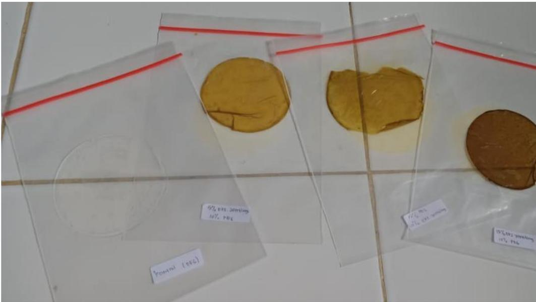
Gambar 11. *Edible film* Karaginan dengan *plasticizer* PEG, dari kiri ke kanan : a. Kontrol, b. dengan penambahan 5% ekstrak daun jamblang, c. dengan penambahan 10% ekstrak daun jamblang, d. Dengan penambahan 15% ekstrak daun jamblang.
