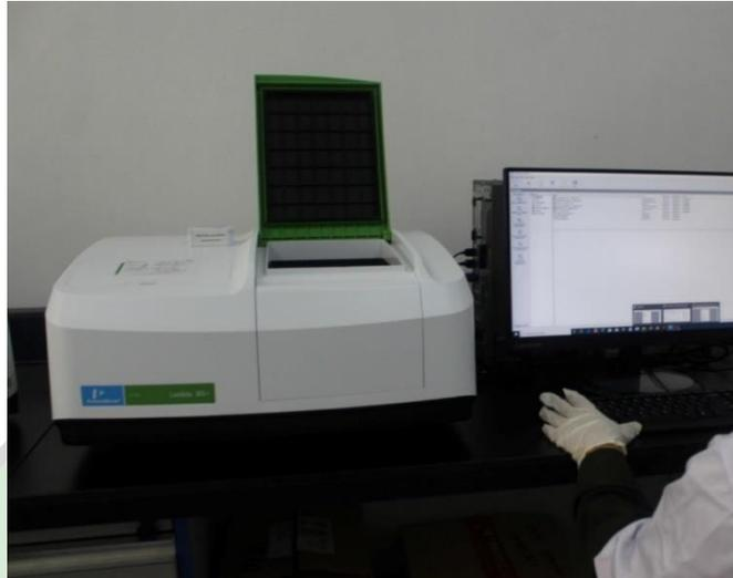
Gambar II. 7 Alat Spektrofotometer UV-Vis
