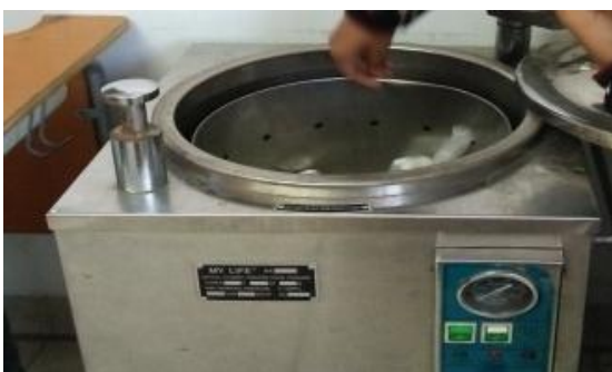
Gambar 6. Autoklaf untuk sterilisasi alat.
