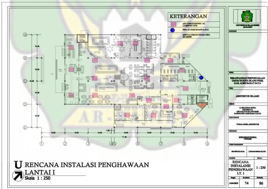
Gambar 6.74 Rencana Instalansi Penghawaan Lantai I
