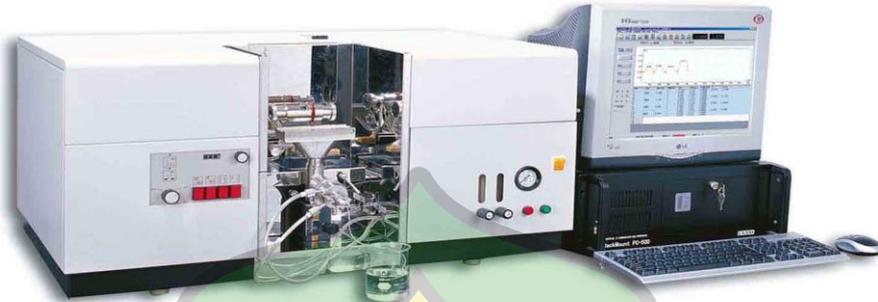
**Gambar 2.3** Alat Spektrofotometri Serapan Atom
