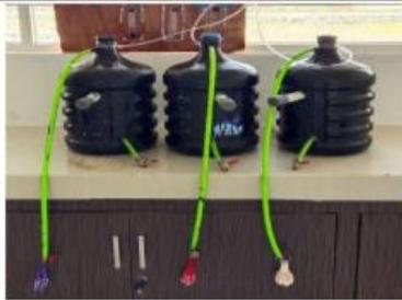
Digester anaerobik di laboratorium Teknik Lingkungan
