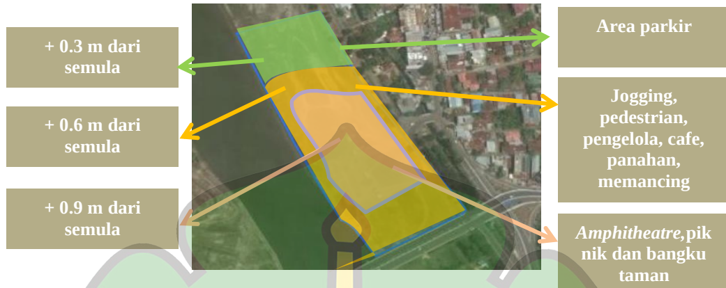
Gambar 4. 19: Penaikan elevasi tanah Sumber : Dokumentasi pribadi
