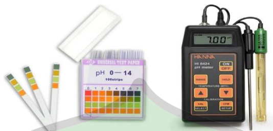
Gambar 2.1 Indikator Universal dan pH Meter (Sumber: Bisa Kimia, 2019)
