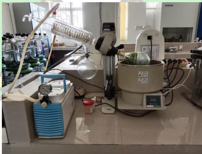
Gambar 5.7 Proses pemisahan ekstrak dengan pelarut menggunakan rotary evaporator
