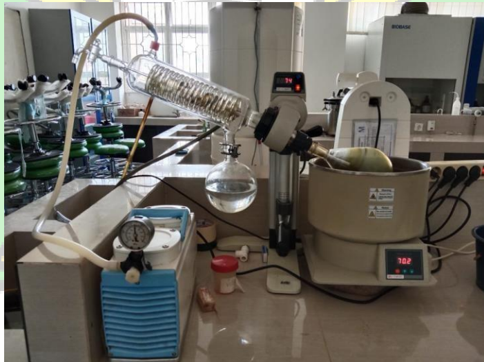
Gambar 5.10 Proses pemisahan ekstrak dengan pelarut menggunakan rotary evaporator
