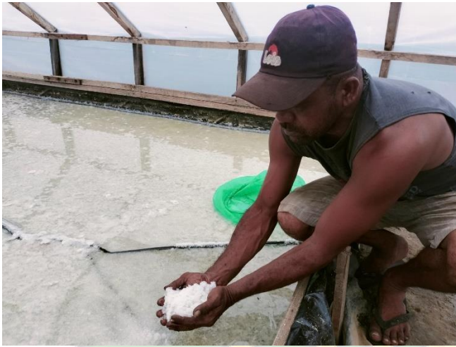
Proses Memanen Garam dengan sistem geomembran
