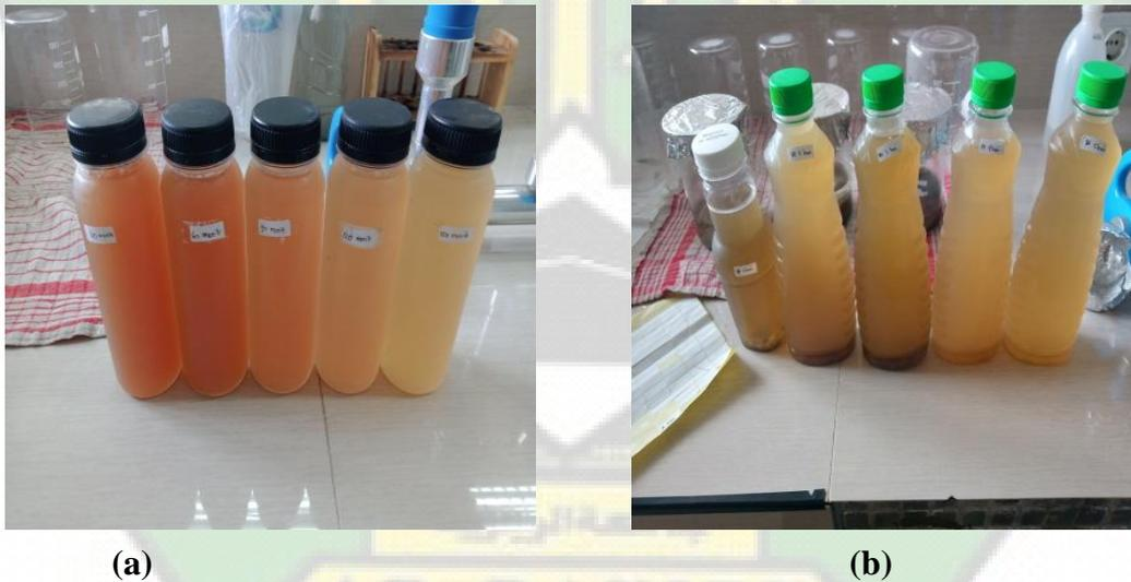
**Gambar 4.1** Limbah cair RPA (a) setelah eksperimen aerasi terdifusi, (b) setelah eksperimen *biosand* filter
