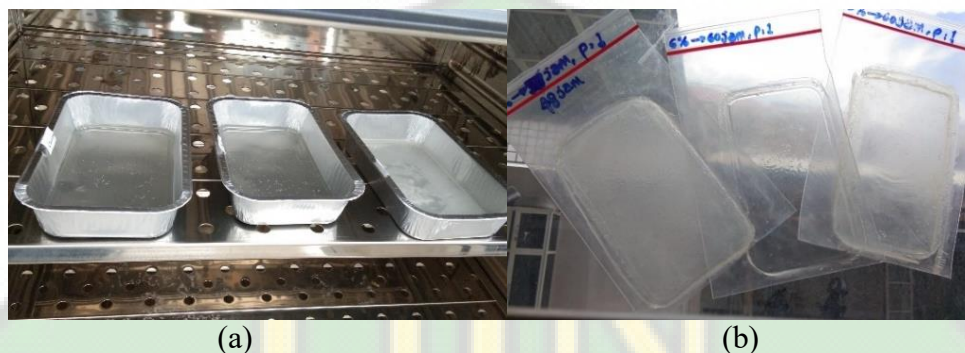
Gambar IV.6 Tahap Pengeringan Gelatin; (a) Proses Drying Gelatin, (b) Gelatin Kering. Sumber: Dokumen Pribadi
