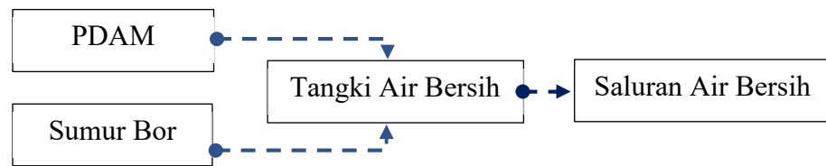
Gambar 5.21 Skema Distribusi Air Bersih
