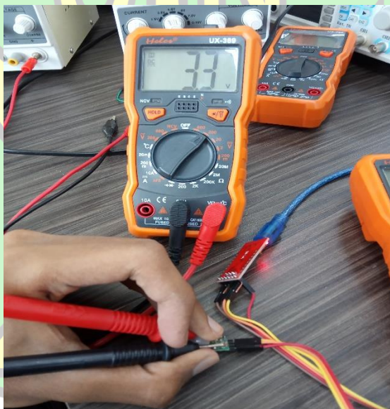
Gambar 4.4 Hasil pengukuran sumber tegangan sensor gerak menggunakan multimeter
