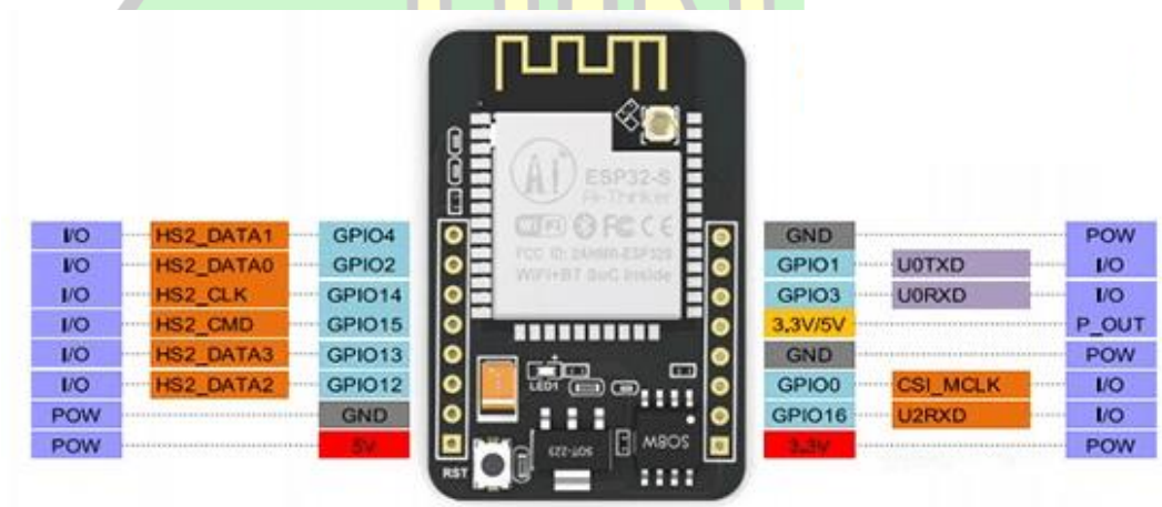
Gambar 2.5 Pin Pada ESP32-Cam
