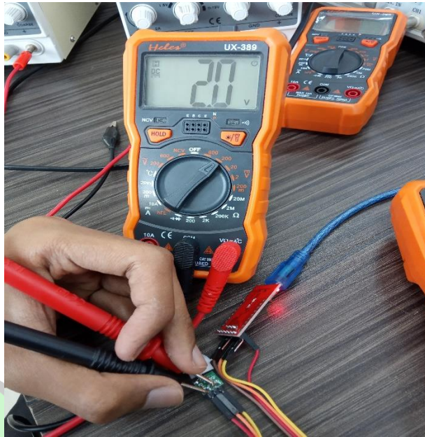
Gambar 4.5 Hasil pengukuran tegangan input sensor gerak menggunakan multimeter
