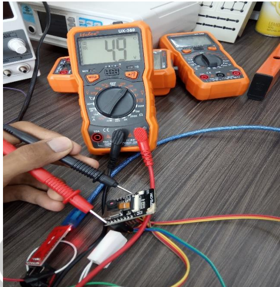
Gambar 4.7 Hasil pengukuran tegangan ESP32-Cam dengan multimeter
