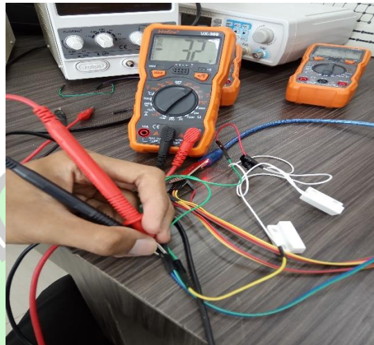
Gambar 4.6 Hasil pengukuran tegangan sensor magnet menggunakan multimeter
