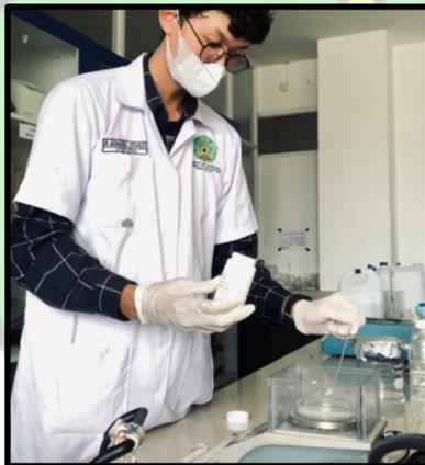
**Gambar 3. 4** Proses menimbang serbuk  $\text{FeSO}_4 \cdot 7\text{H}_2\text{O}$
