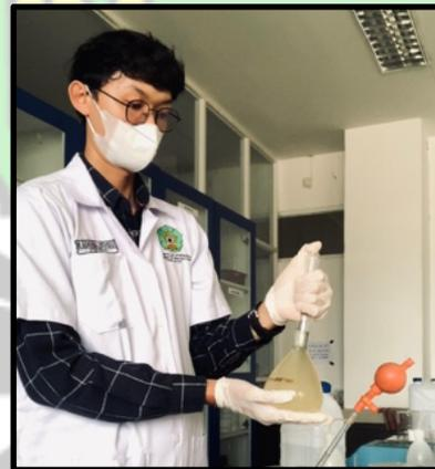
**Gambar 3. 5** Proses homogenisasi pada pembuatan larutan induk Fe 500 ml
