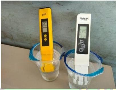
Gambar 3.4 Pengukuran Dengan Tester Air (Ph Meter) Digital
