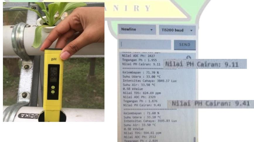
**Gambar IV.10** Uji Kalibrasi dengan Air Hidroponik
