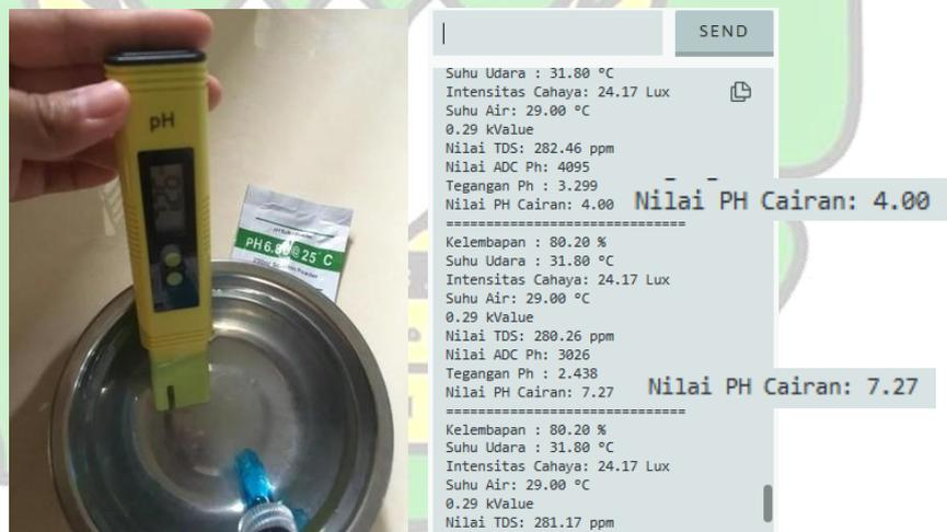
**Gambar IV.8** Uji Kalibrasi dengan *Buffer* pH 7
