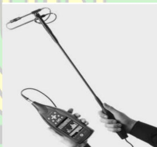
**Gambar 2.2** Pengukur Intensitas Bunyi
