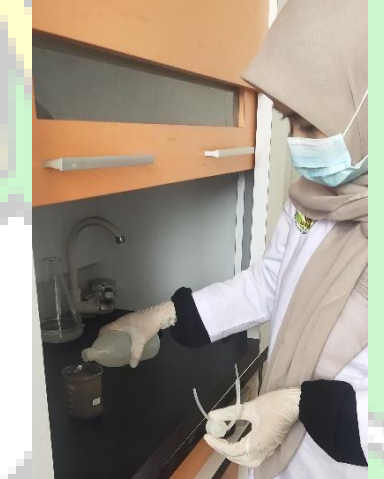
Pencucian magnetit sampai pH normal
