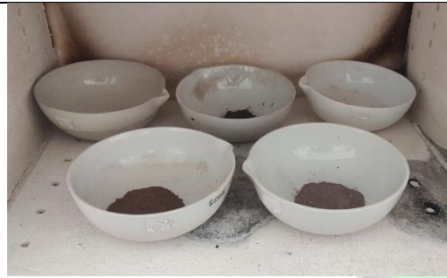
Magnetit-TiO 2 setelah di furnance
