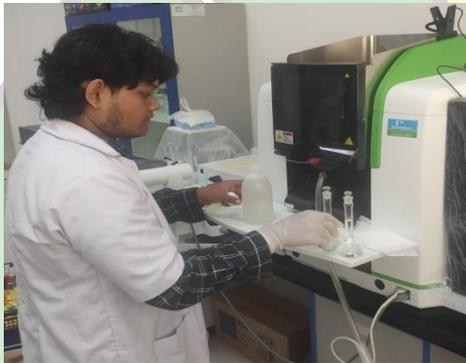
Pengujian adsorpsi timbal menggunakan AAS
