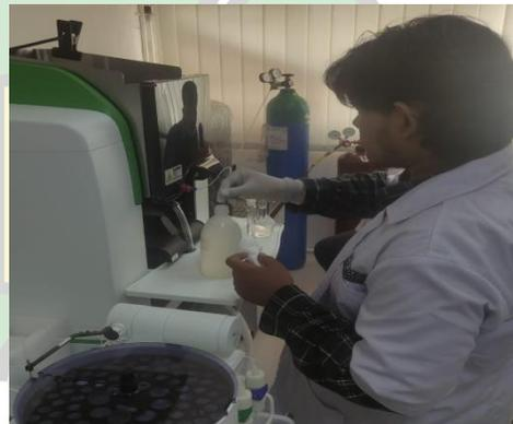
Pengujian adsorpsi timbal menggunakan AAS
