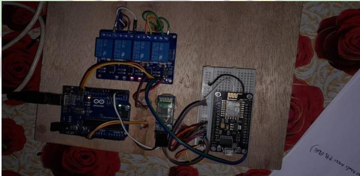
Lampu indikator relay berfungsi pada mode wi-fi
