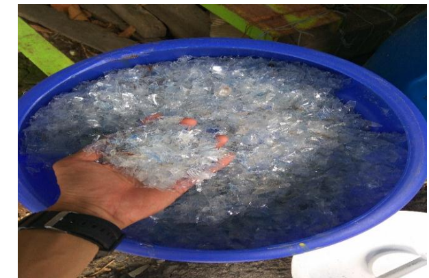
Mesin pencacah plastik aqua dan sudah jadi biji plastik Aqua yang sudah dibersihkan dan dipisahkan tutup, lebelnya dan setelah itu aqua dimasukkan kedalam mesin pencacah dan hasilnya menjadi biji plastik
