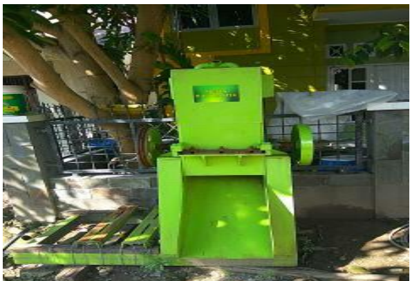
Mesin pencacah plastik aqua dan sudah jadi biji plastik Aqua yang sudah dibersihkan dan dipisahkan tutup, lebelnya dan setelah itu aqua dimasukkan kedalam mesin pencacah dan hasilnya menjadi biji plastik
