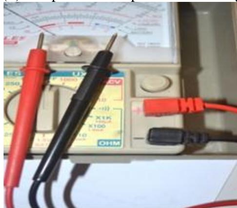
Cara Pemasangan Probe Multimeter
