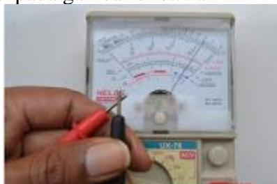
Menghubungkan probe multimeter
