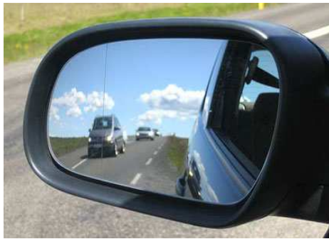
Gambar 2.3 Bayangan pada cermin cembung
