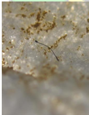
Gambar 4.7 Hasil Citra Di Bawah Mikroskop Binokuler Untuk Mikroplastik Berbentuk Fiber Berwarna Hitam (warna lainnya)
